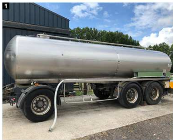
1. L'eau traitée est conservée dans une cuve avant d'être déversée dans le pulvérisateur.
